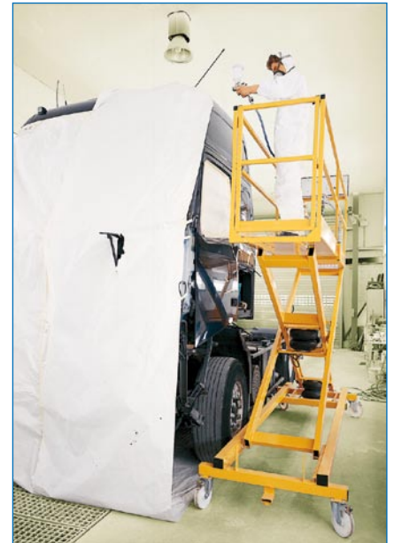
Auf der Plattform sind Anschlüsse für Druckluft. Alle Arbeitsmittel sind auf dem gehobenen Personenlift jederzeit griffbereit.
