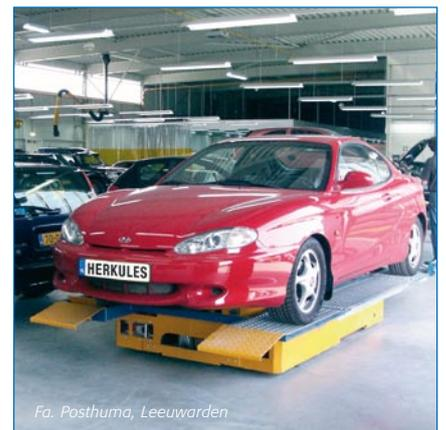
Mit nur einer Person können in Arbeitsposition gebrachte Pkw problemlos und sicher in der Werkstatt rangiert werden - ohne Aufreißen von Abklebungen und ohne schädliche Auspuffgase.
