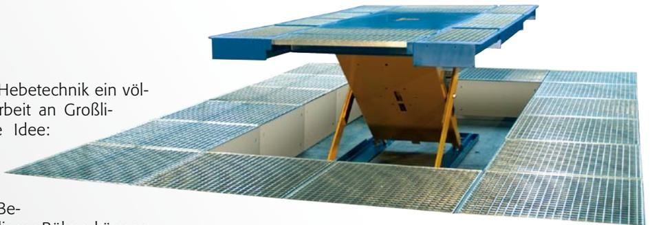
Mit 3 to Hubkraft ist sie für schwere Fahrzeuge geeignet und der erweiterte Hub durch den 3-fach Luftbalg schafft immer stufenlos einstellbare optimale Arbeitshöhen.
