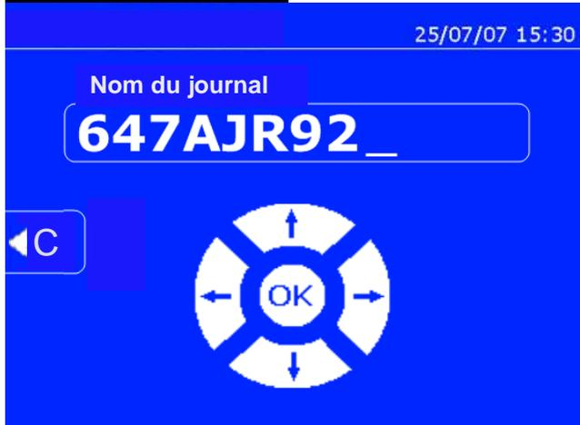
Запись отчёта позволяет сохранить данные по серии сварных точек, совершенных с помощью клещей, с тем, чтобы записать их на карту памяти (чип) и потом вывести их на компьютер. GYS предоставляет компьютерную программу, которая называется GYSPOT, позволяющую считывать информацию с SD карты и распечатывать отчёты на компьютере. Эта программа GYSPOT находится на SD карте вместе с инструкцией по эксплуатации.
