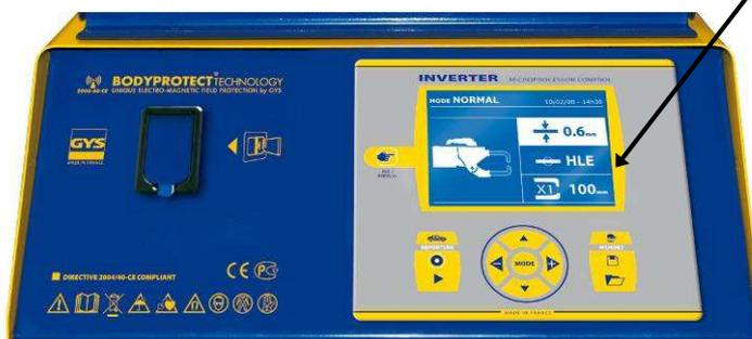
Электронный дисплей для программирования аппарата пользователем
