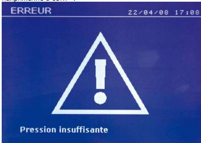
Повторное нажатие на гашетку позволяет « принудительно » выполнить сварную точку с имеющимся напряжением. Если замеренная сила сжатия недостаточна, то аппарат афиширует сообщение « Слабое сжатие ». Запись «слабое сжатие» также заносится в текущий отчет.
