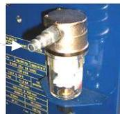
✓ **Наполнение резервуара жидкостью охлаждения**
