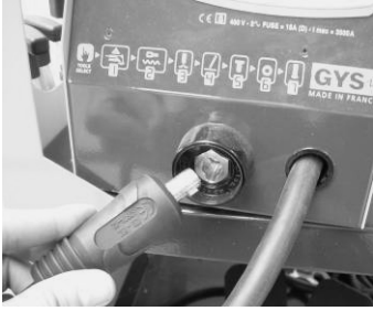
❶ Подключите к генератору
